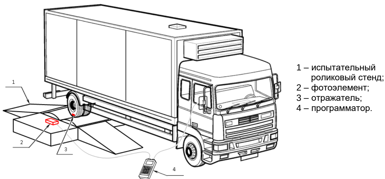
Рисунок 29. Определение параметра w на роликовом стенде
